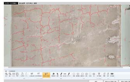
③ 画像を自動合成し、ひびを自動検出
